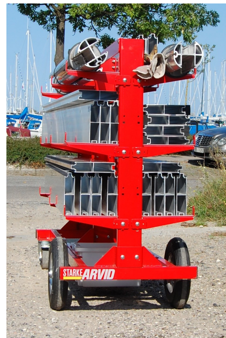
Til opbevaring og transport af barrierens mobile dele er valgt en STARKE Arvid lægtevogn
