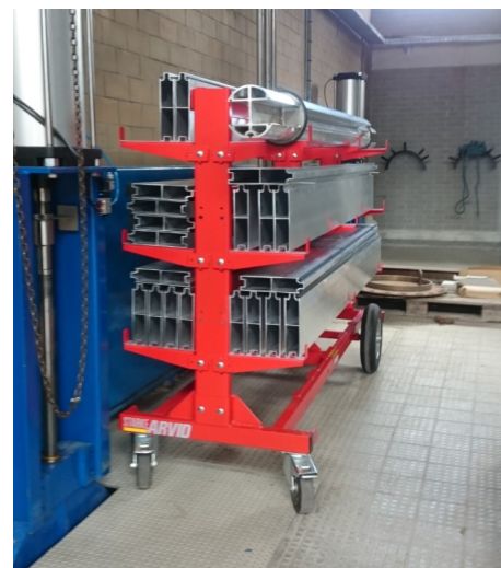
Hallen er opvarmet og tør. Bjælkerne holdes adskilt med plast afstandsstykker.
